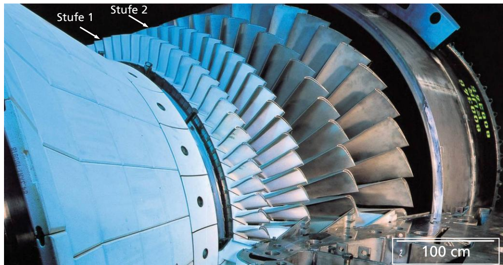
Bild 1 : Brennkammer und Turbinenbereich einer Industriegasturbine des Typs SGT6-4000F [Quelle: Siemens PG]
