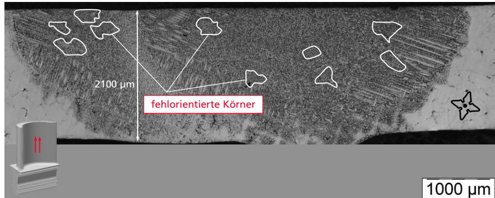
Bild 113 : Querschliff von zwei umgeschmolzenen Spuren, maximale Umschmelztiefe: z_m = 2100 \mu\text{m} maximale Wandstärke der Turbinenschaufel 2100 \mu\text{m} , T_V = T_{V2} d = d_1 v = v_3 P = 750 \text{ W}
