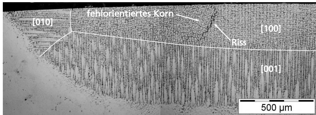
Bild 17 : Teil eines Querschliffs einer umgeschmolzenen Spur aus PWA 1483
