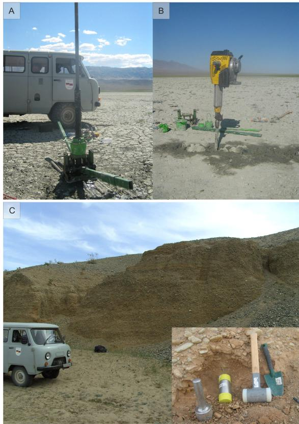
**Abb. 3: Geländearbeiten im Süden der Mongolei; A und B: Durchführung der Bohrungen; C: Entnahme von OSL Proben**
