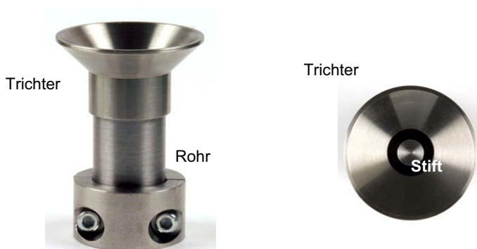
Abb. 6.2.2: Gießvorrichtung; Seitenansicht (links) und Draufsicht (rechts)
