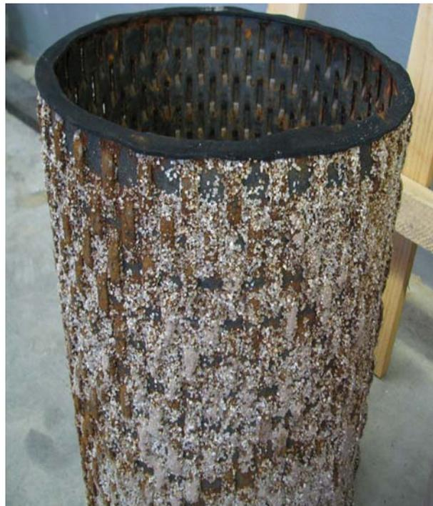
Abbildung 6.26: Ausgebauter Schlitzbrückenfilter ohne Kiesbeklebung nach einer Woche im Versuchsstand
