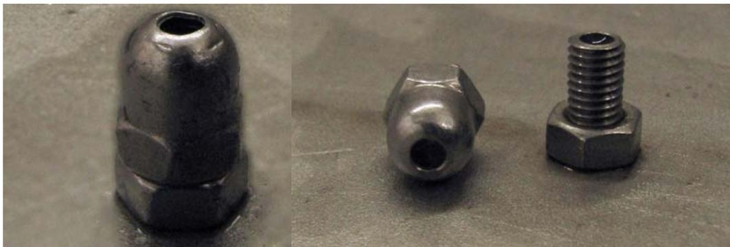
Abbildung 4.8: Aufgebohrte Deckelmutter als Kappe für die Druckanbohrung
