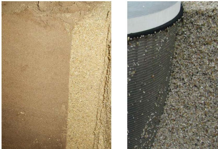
Abbildung 6.21: Beispielhafte Trennflächen zwischen Aquifermaterial und Filterkies (links) und Filterkies und Filterrohr (rechts) mit unterschiedlichem Maßstab
