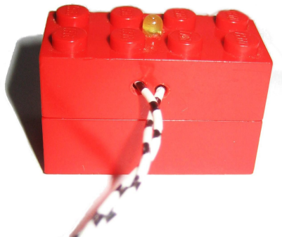
Abbildung 2.9: Selbst gebaute Lego-Lampe: in Legostein eingebaute Leuchtdiode
