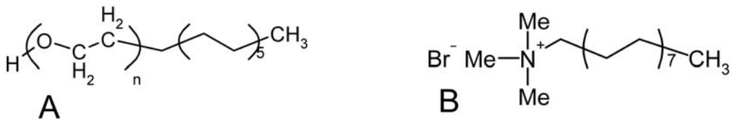
Abb. 81: A: Deyhdol LS 9.5 für n= 9.5 , Arylpon F für n= 2.5 ; B: Cetyltrimethylammoniumbromid (CTAB).
