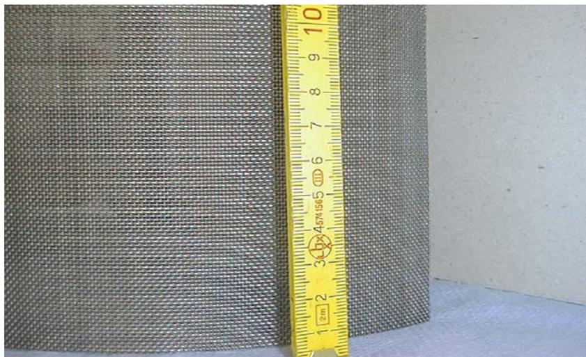
Abbildung 3.6: Poröse Brenneroberfläche aus hochwarmfestem Material
