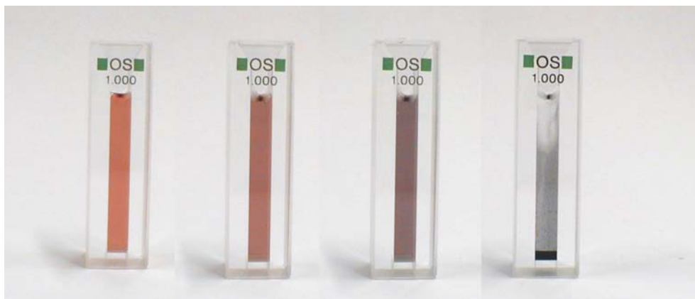
Abb. 5.23: Foto der konzentrationsabhängigen Vernetzung von Gold-Nanopartikeln mit cis -Pt (von links nach rechts: V_{cis-Pt} = 0, 0.5, 1.25, 2.0 \mu\text{L} ).
