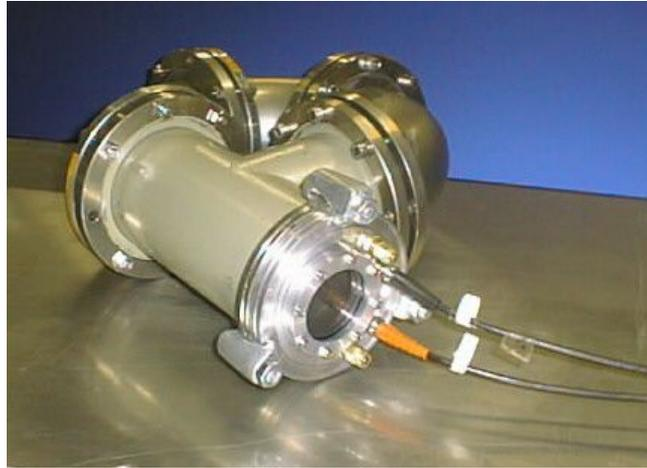
Bild 16: Rezipient C (Durchmesser 100 mm) für die Staubverwirbelung zur Untersuchung von Staubpartikel in einer Gasatmosphäre.
