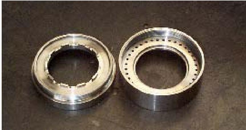
Bild 48: Ansicht des Fensterhalters am Kopf der Sonde. Der Raum zwischen Messsonde und Messkopf wird mit Stickstoff gespült, der durch die kreisförmigen, konzentrisch angeordneten Öffnungen (rechts) in den Fensterhalter geführt wird und durch die Spalten (links) gepresst wird, so dass das Beobachtungsfenster radial gespült wird.
