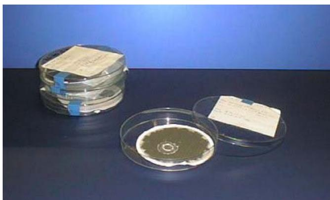
Bild 6: Auf Quarzfiltern aufgetragener Gichtstaub für die lasergestützte Elementanalyse im Labor.
