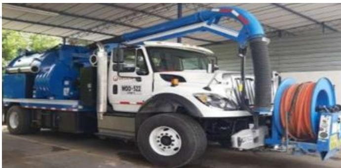
Figura 76 Vehículo de Succión Precisión
