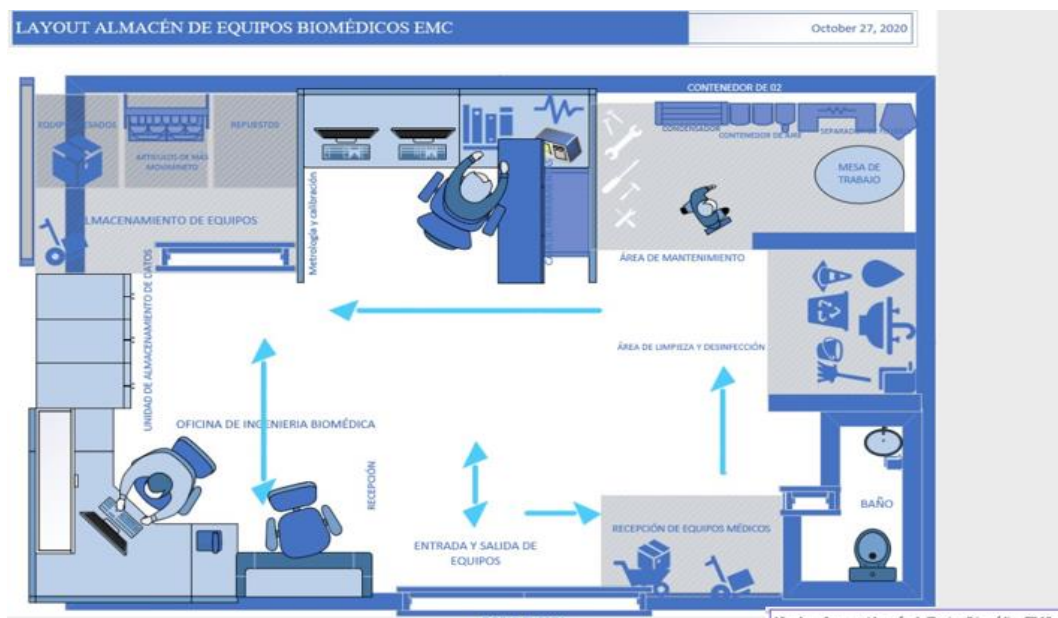
Ilustración 35: Propuesta plano Layout equipo biomédico de la clínica EMC
