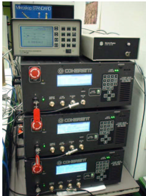
Abbildung 8.3: Foto der verwendeten Pumpdioden. Auf den Gehäusen der Dioden stehen das Energiemessgerät und das Netzteil des Justierlasers.
