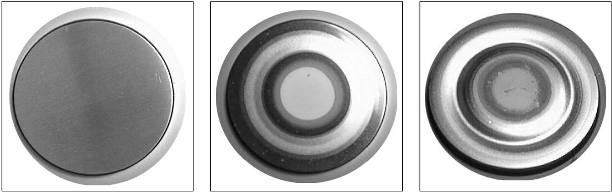
ABBILDUNG 7.7: Fotos der beiden verwendeten Wolfram Sputtertargets. Links ist das unbenutzte neue Target abgebildet, in der Mitte dasselbe Target nach 10 Stunden Sputterbetrieb. Das Foto rechts zeigt das alte Target nach etwa 100 Betriebsstunden. Abbildung 7.8 zeigt die zugehörigen Höhenprofile der Targetoberflächen.
