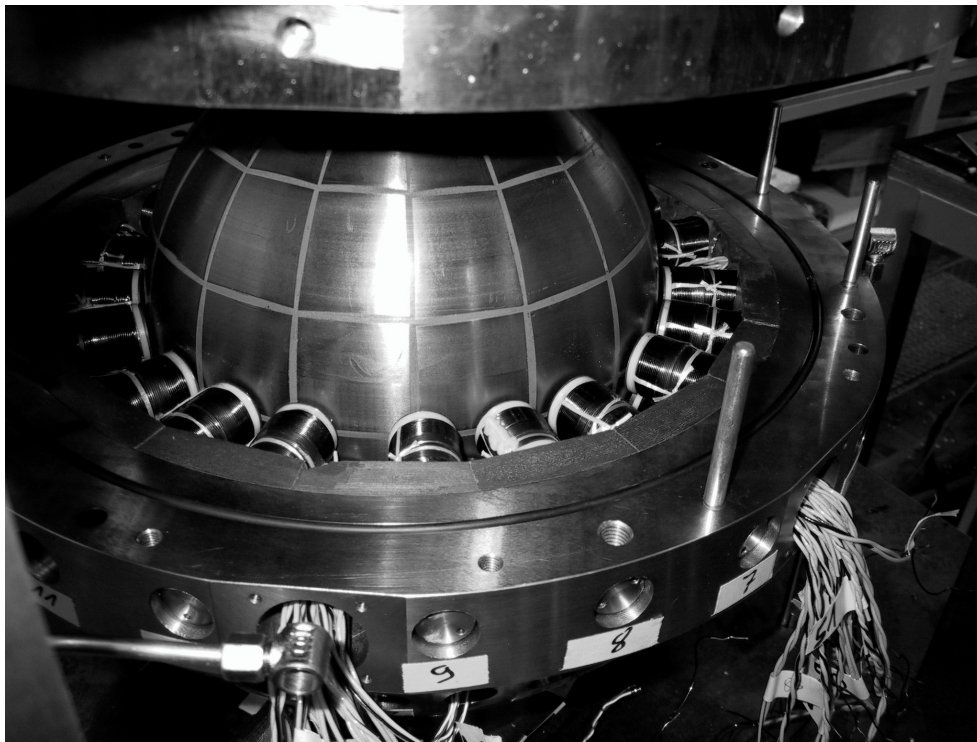
Bild C.9 Rotor in Statorgehäuse vor Montage der oberen Lagertaschen
