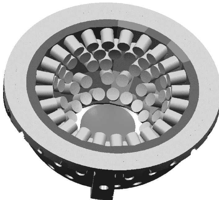
Bild C.5 Statorgehäuse mit innen liegenden Rückschlusselementen und Statorpolen
