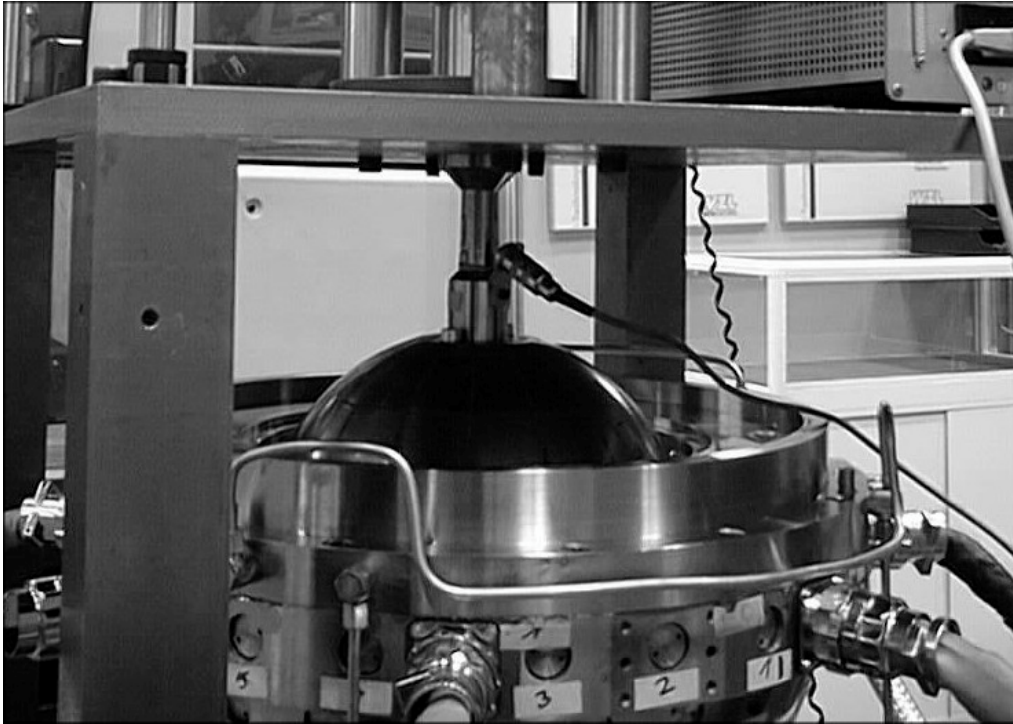
Bild C.10 Kugelmotor mit Klemmung um die Rotorflanschachse
