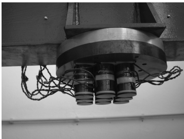
Bild C.2 Vollschrmmetrische Anordnung mit 9 Statorpolwicklungen (links) und alternative Anordnung mit 16 Statorpolwicklungen und Magnetflussleitstücken (rechts)
