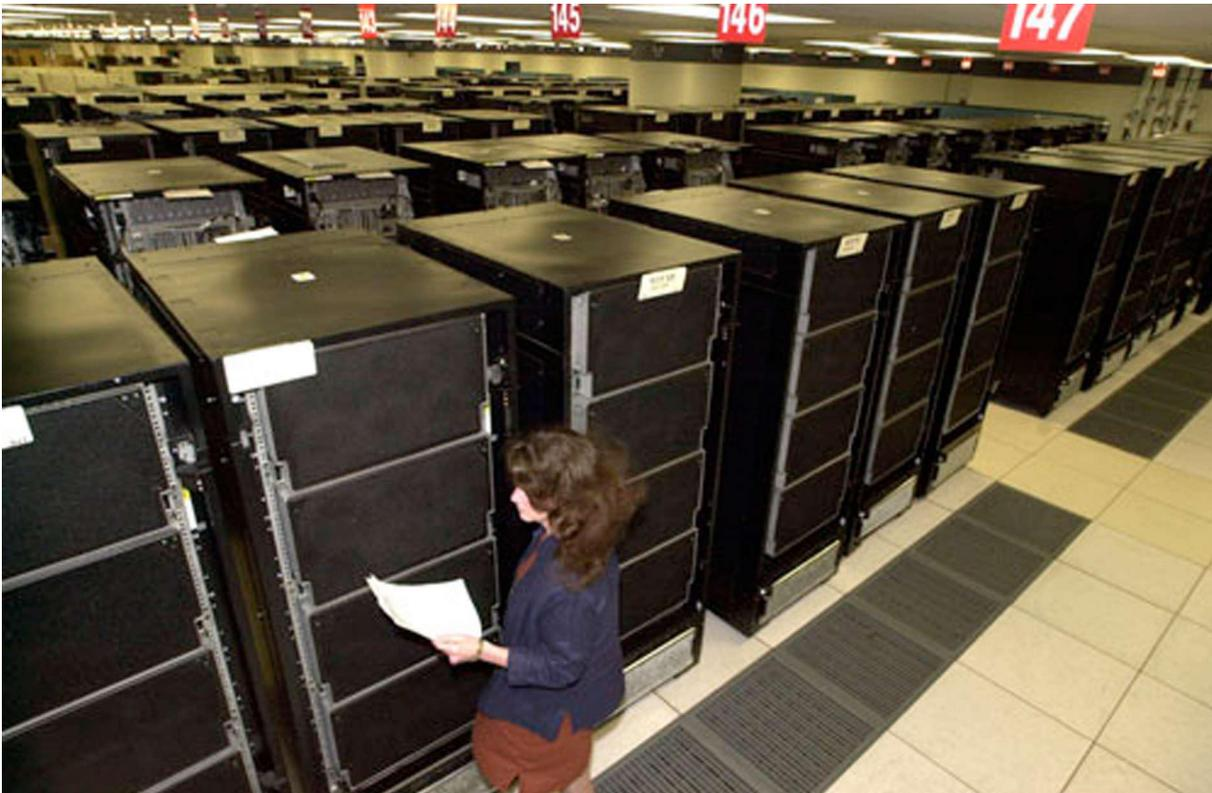
**Abb.214** Supercomputer RS/6000 SP „ASCI White“, gebaut von der Firma IBM. Photo: IBM
