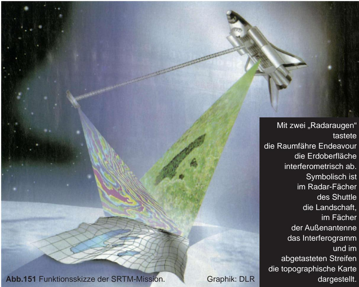
Mit zwei „Radaräugen“ tastete die Raumfähre Endeavour die Erdoberfläche interferometrisch ab. Symbolisch ist im Radar-Fächer des Shuttle die Landschaft, im Fächer der Außenantenne das Interferogramm und im abgetasteten Streifen die topographische Karte dargestellt.
