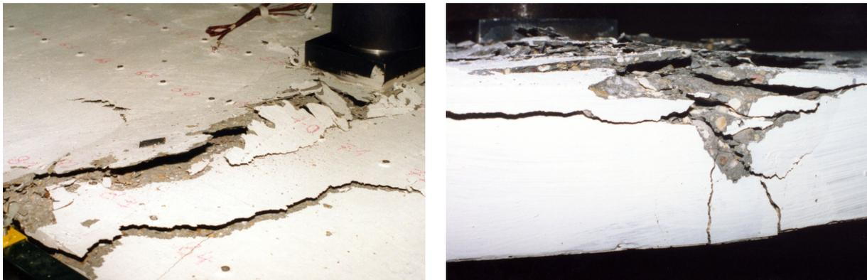
Bild 6.10: Versagen der hochfesten Betondruckzone
