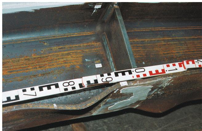
Bild 6.32: Gewählter Fließlinienmechanismus und Beulform im Versuch
