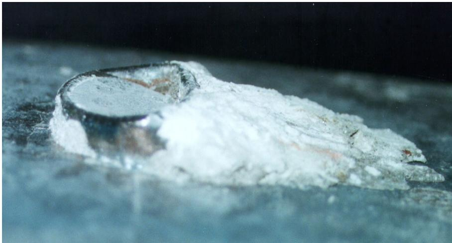
Bild 4.47: Aufgeschobener Betonkeil vor dem Schweißwulst mit Abscherfläche
