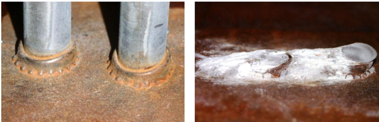
Bild 4.18: Doppeldübel **ohne** Querbewehrung nach dem Schweißen (links) und nach dem Versuch (rechts)
