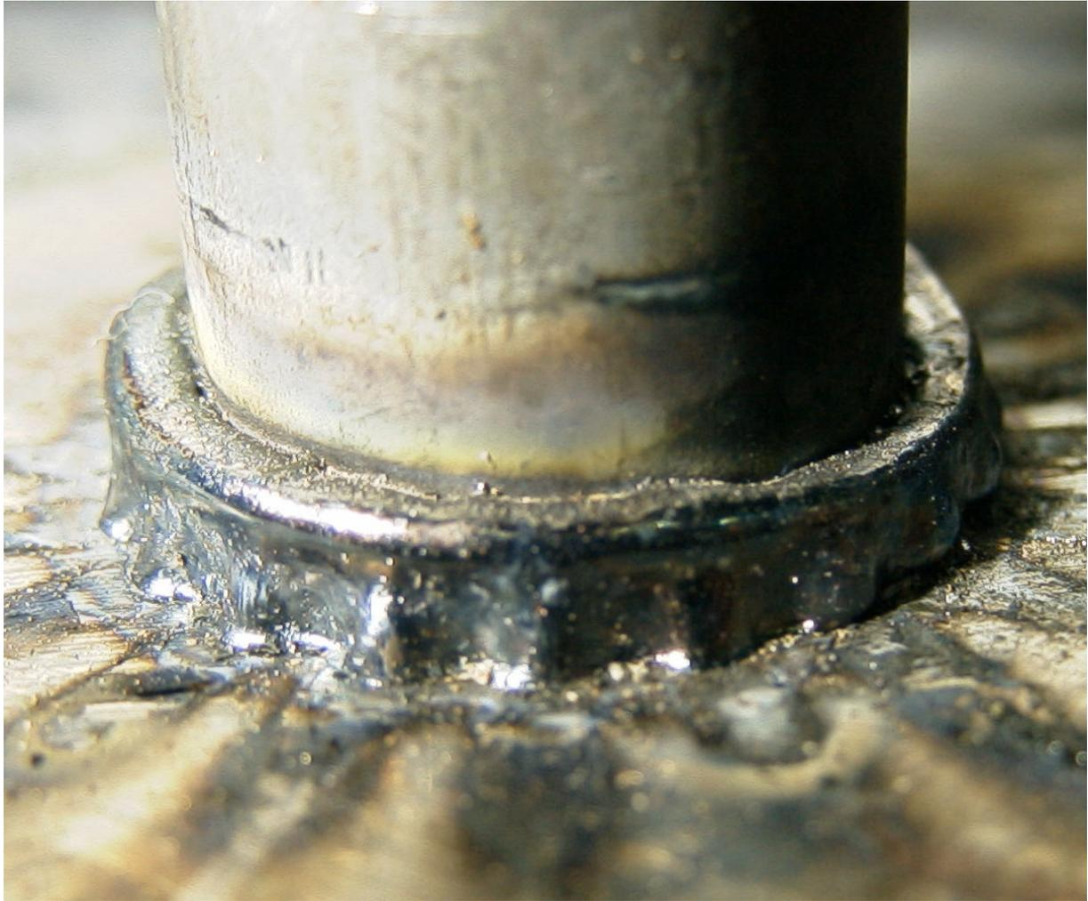
Bild 4.41: Hochfester Dübel nach dem Schweißen
