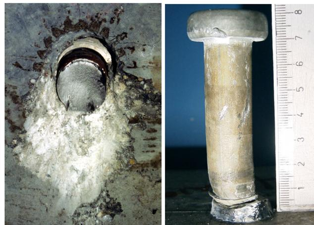
Bild 4.35: Versuchsergebnisse Serie 29 (links), Bruchfläche im Beton (Mitte) und verformter Dübel (rechts)
