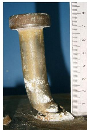
Bild 4.23: Versuchsergebnisse Serie 21 (links), verformter Dübel (rechts)
