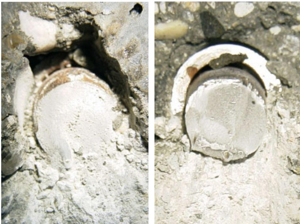
Bild 4.39: Dübel im Beton nach Versuch 1 (links) und nach Versuch 2 (rechts)
