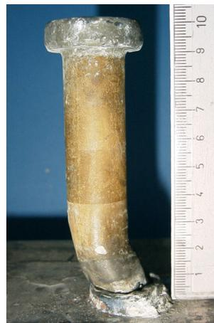
Bild 4.25: Versuchsergebnisse Serie 22 (links), verformter Dübel (rechts)
