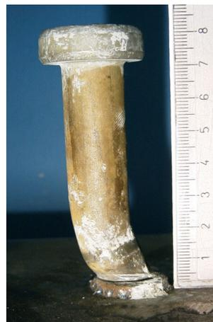
Bild 4.21: Versuchsergebnisse Serie 20 (links), verformter Dübel (rechts)
