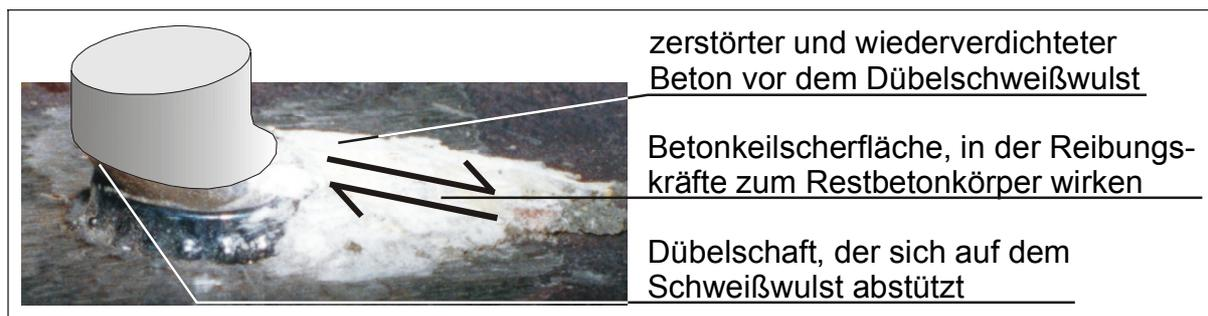
Bild 5.10: Betonversagen vor dem Schweißwulst: Plastizieren und Abscheren
