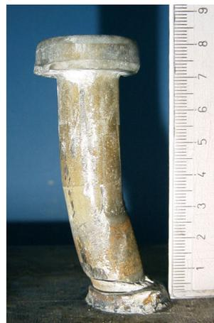
Bild 4.33: Versuchsergebnisse Serie 28 (links), verformter Dübel (rechts)
