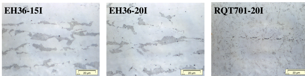
Bild 4.21: Mit der Natriumpikrat-Ätzung ersichtliche Karbide für den GW der Stähle EH36-15I, EH36-20I und RQT701-20I bei x1000 Vergrößerung
