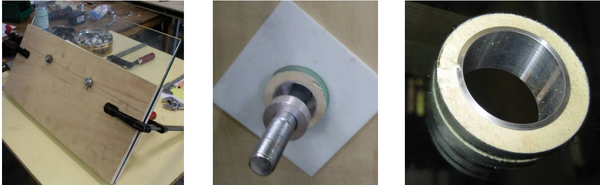
Bild 8.5: Herstellen des Hülsevenvergusses
