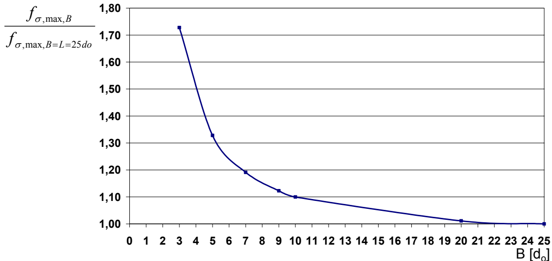
Bild 5.19: Spannungszunahme bei abnehmender Scheibenbreite B, FEM
