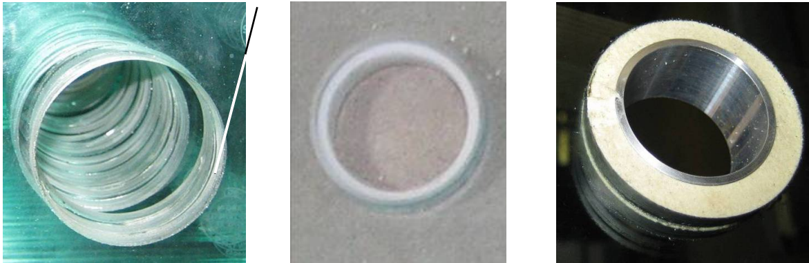
Bild 2.7: Versatz zwischen Einzelscheiben bei VSG im Bohrungsbereich (links), vorgefertigte Kunststoffhülse (Mitte), Vergussmaterial mit zusätzlicher Aluminiumhülse (rechts)
