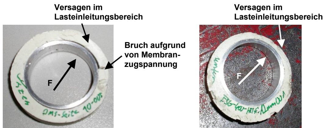
Bild 8.8: Ausgebaute Mörtelringe nach Versuchsdurchführung
