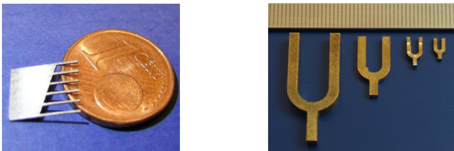
Abb. 3.4: Lasergeschnittene Balkenplatte mit theoretischen Eigenfrequenzen zwischen  $10$  und  $28 \text{ kHz}$  (links) und (rechts) vier gefräste Stimmgabeln unterschiedlicher Größe mit Zinkenlängen von  $L = 4, 6, 12$  und  $21 \text{ mm}$
