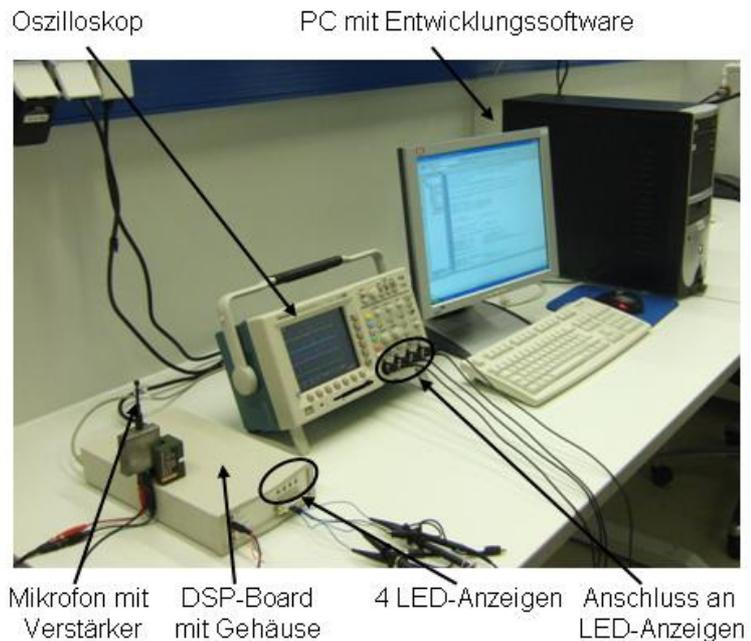
Abb. 7.8: Versuchsaufbau DSP-Empfängersystem
