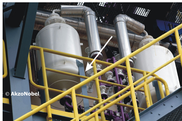
b) Apparatfüße aus Blechen für stehende Behälter [86]
