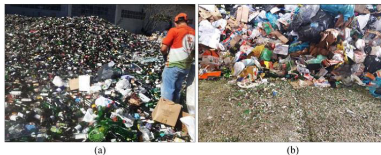
Figura 5: (a) armazenamento e triagem das embalagens de vidro no pátio externo da ACMR; e (b) cacos de vidro no chão do galpão da ACMR, provenientes da coleta seletiva porta a porta single-stream com compactadores. Fonte: Imagens registradas pelos autores no local.
