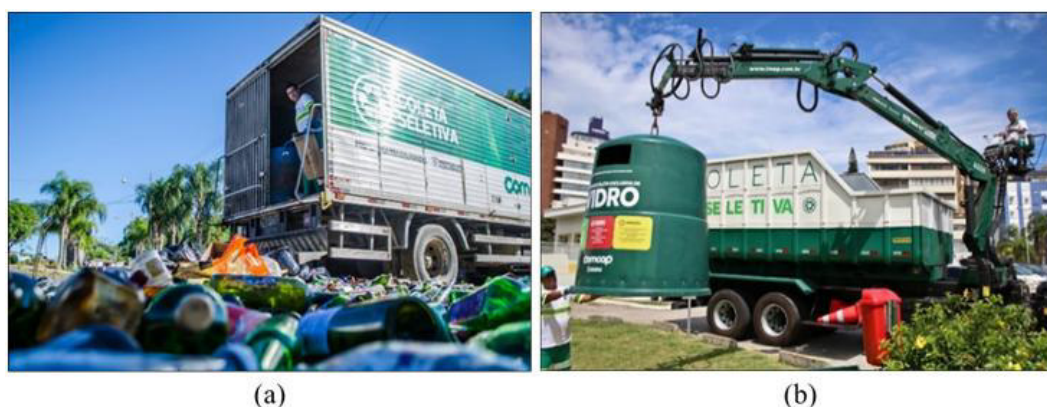
Figura 3: (a) caminhão do tipo baú usado na coleta seletiva porta a porta descarregando as embalagens de vidro armazenadas nos tonéis, e (b) caminhão com guindaste e caçamba basculante usado na coleta exclusiva do vidro por meio de PEVs.
