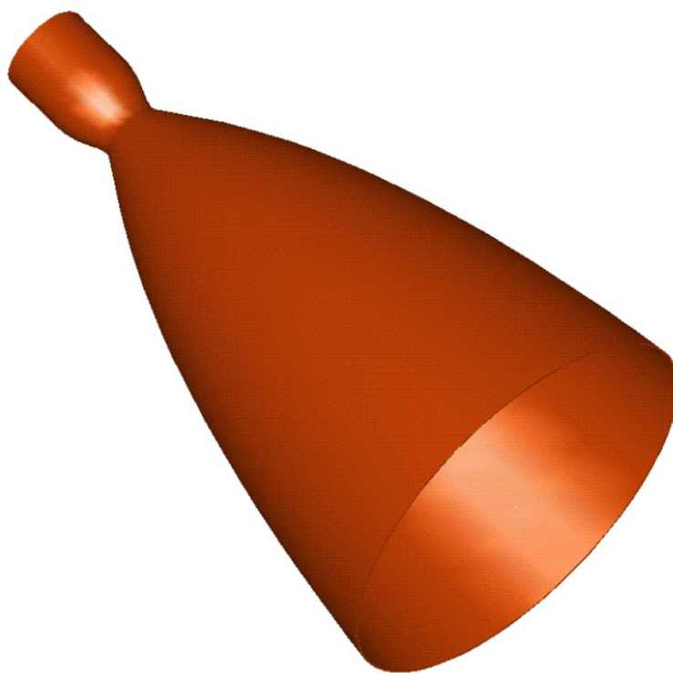
Abb. 5.31: CAD Modellierung der Schubkammer des SE-22
