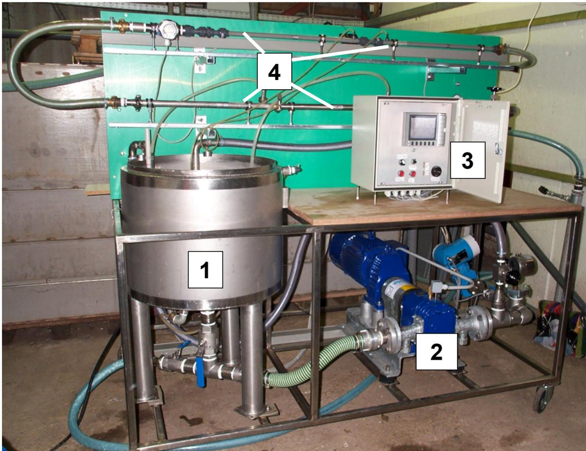
**Abbildung 4-2: Teststand für Crossflow-Membranmodule (MF/ UF):**
