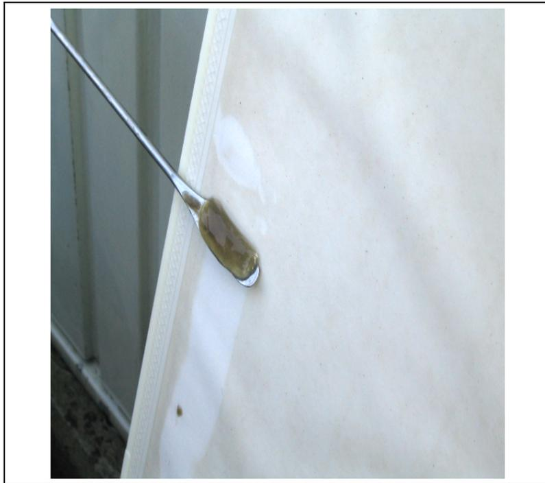
**Abbildung 5-1:** Foto des gelartigen Membranbelags bei Behandlung des Abwassers T2
