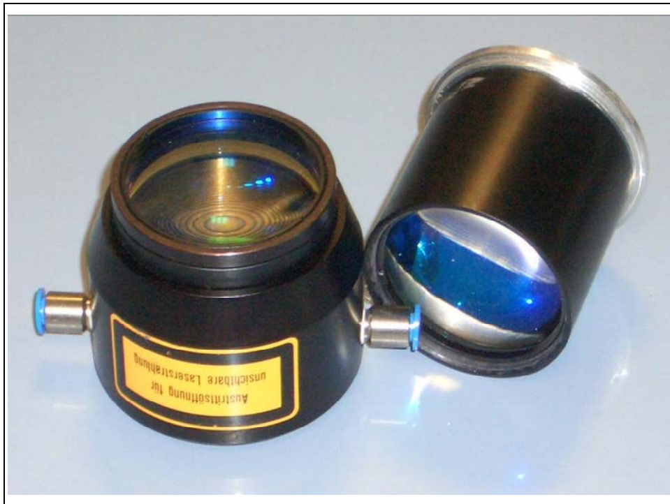
Abbildung 12: Linsensystem mit definierter Brennweite von f=65\text{mm}
