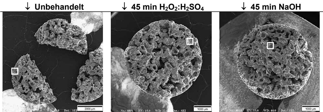
Abbildung 6.11: REM (SE) – Übersichten von Ecopore Zylindern nach Korrosionsversuchen zur Erhöhung der OH-Gruppenzahl. V.l.n.r.: unbehandelte Referenz, 45' H 2 O 2 :H 2 SO 4 , 45' NaOH
