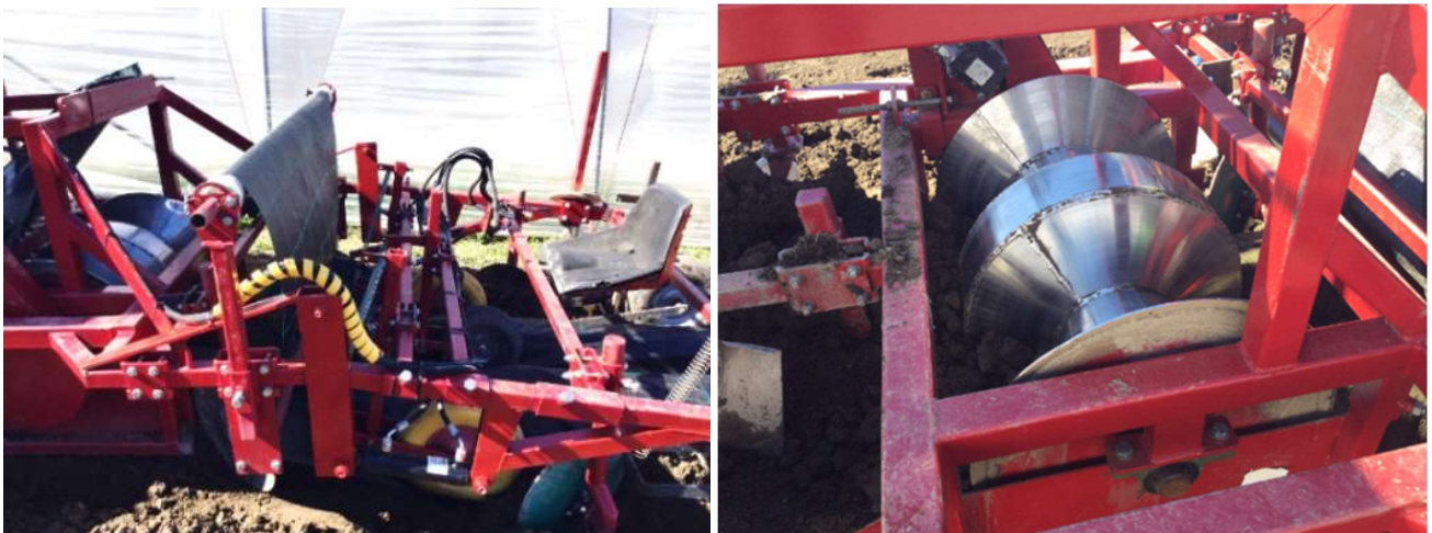
Kuva 3. Kourupenkintekokoneessa keskellä sijaitseva pyörä muotoilee penkin keskelle kourun ja tiivistää penkin reunat
