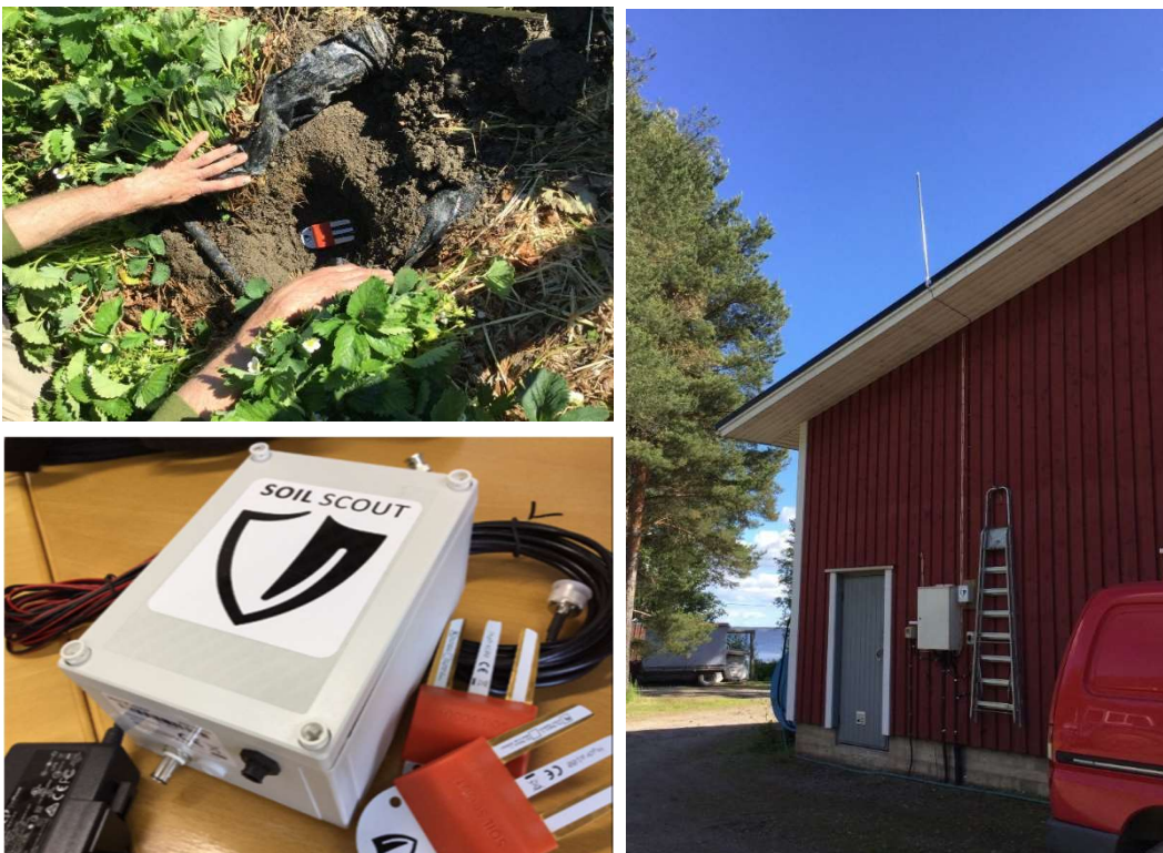
Kuva 7. SoilScout-laitteistoon kuuluu keskusyksikkö, antenni sekä langattomat anturit. Keskusyksikkö toimii verkkovirralla, joten se on sijoitettava virtalähteen lähelle.
