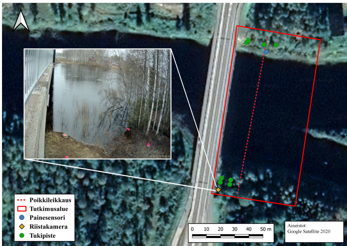
Kuva 12: Kurenaluksen tutkimuskohde. Riistakamera kiinnitettiin siltaan ja kuva-alalta mitattiin virtaama-analyysiin tarvittavat tukipisteet. Poikkileikkaus saatiin vertailuaineistona käytettyjen ADCP-virtaamamittausten yhteydessä. Vedenkorkeus mitattiin painesensorilla.
