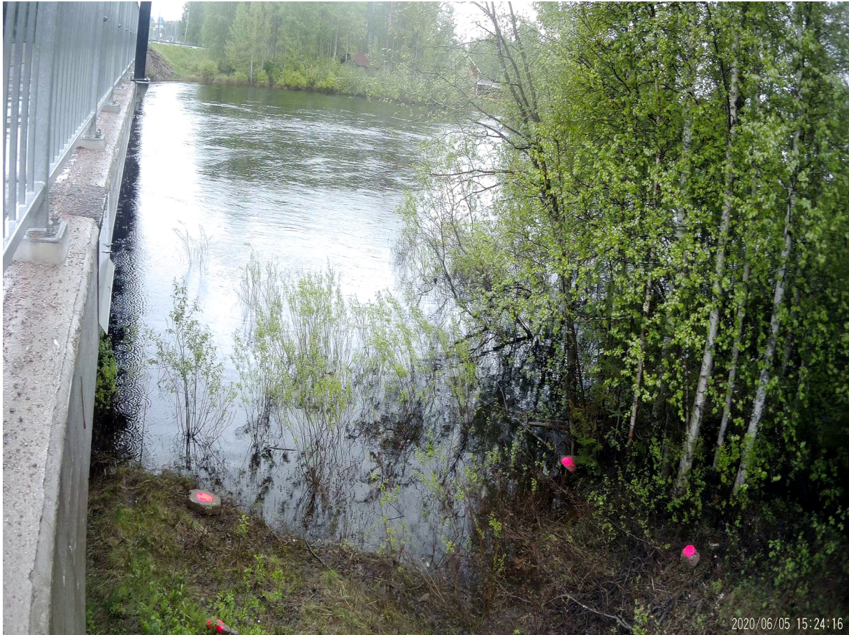
Kuva 46: Kuraluksen tutkimuspaikalla riistakameran 4K-resoluutiolla kuvatun videon kuva-kaappauksesta on nähtävissä voimakas tynnyrivääristymä. Lisäksi kuvasuhde (2880*2160 eli 4:3) on eri kuin pienemmällä resoluutiolla.
