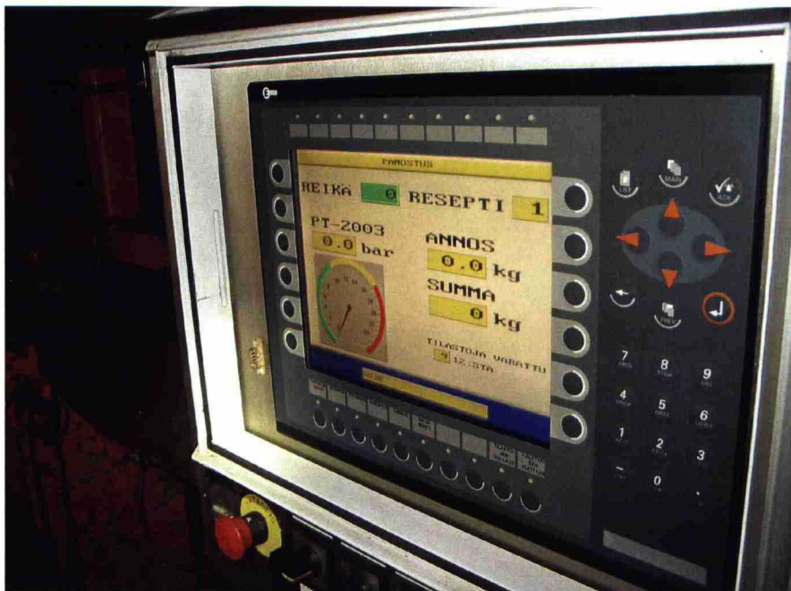
Kuva 24. Panoskoot luettiin emulsiopanostuslaitteen näytöltä 100 gramman tarkkuudella.
