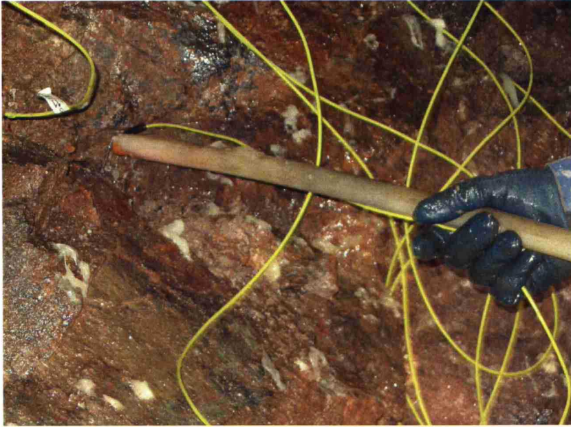
Kuva 25. Nobel Prime sytytin ja nalli työntyy panostusputken edellä porareikään emulsiopanostusmenetelmässä.
