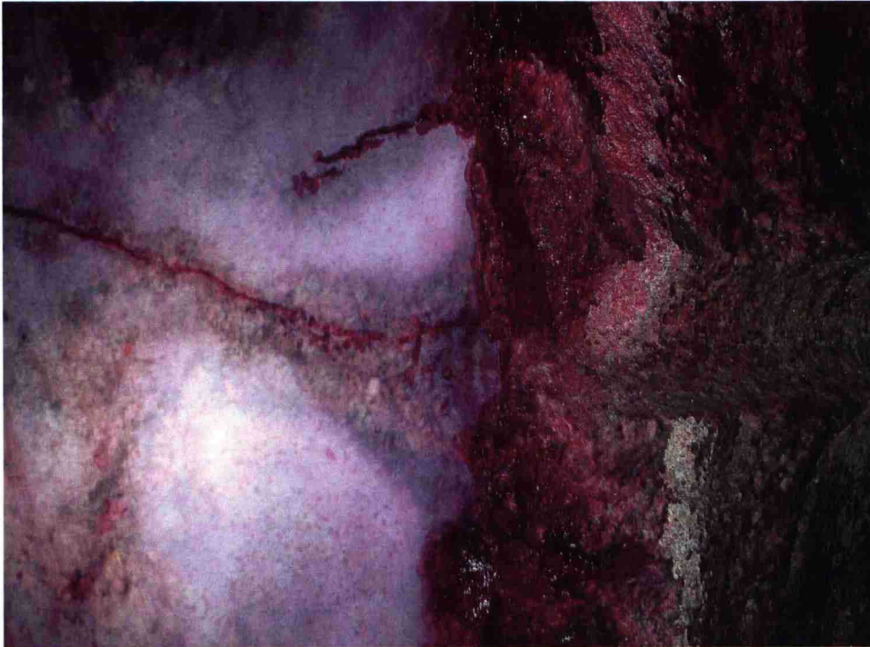
Kuva 32. Porareiän puolikkaasta lähtevä rako paljastuu selkeästi tunkeumanesteen ja kehittimen avulla.
