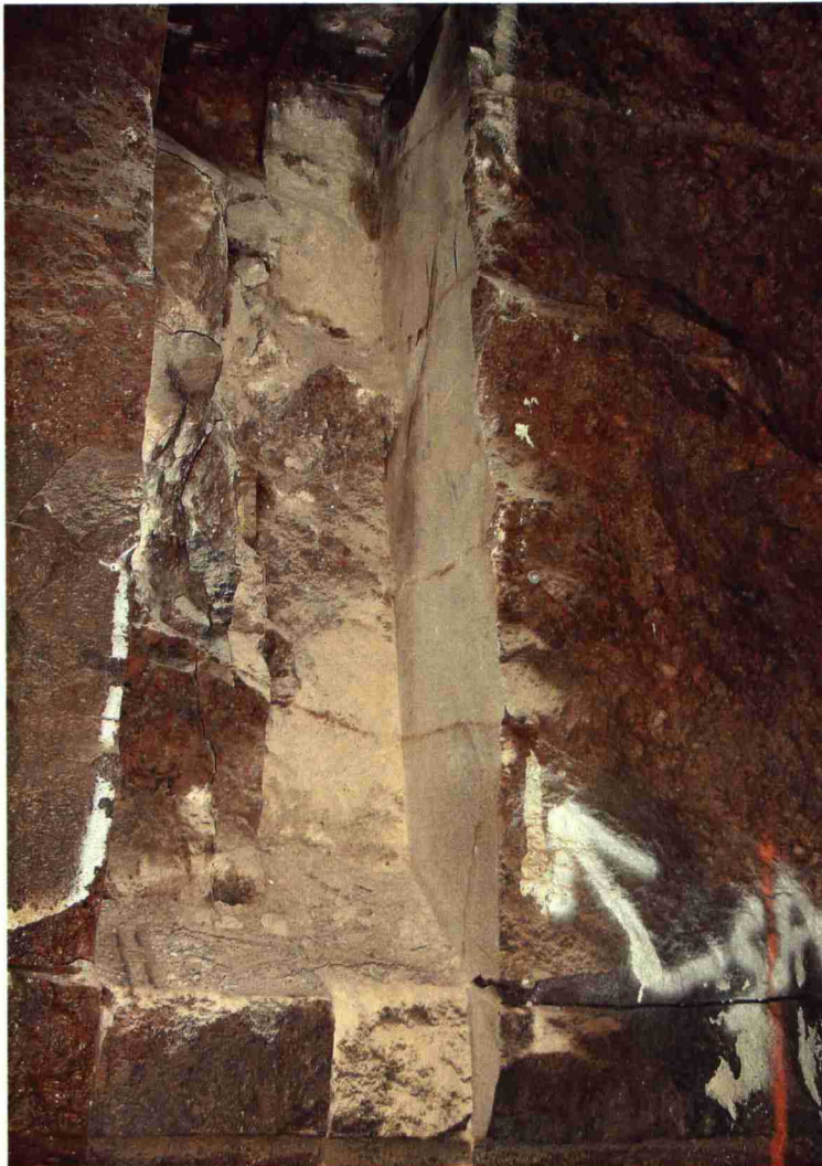
Kuva 29. Räjähdysaineen aiheuttamia rakoja on jo nähtävillä patruunakatkon kohdalla suoritetusta sahauksesta.
