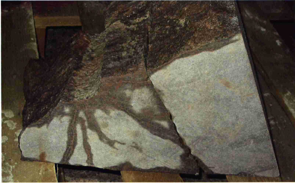
Kuva 43. Porareistä lähtevä rakoilu katkesi luonnolliseen rakoiluun.
