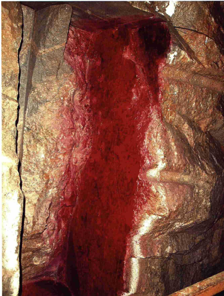
Kuva 31. Tunkeumaneste on suihkutettu sahatulle poikkileikkauspinnalle.
