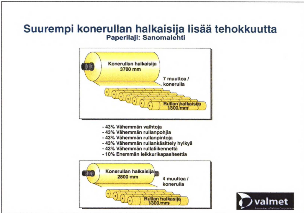
Kuva 2. Konerullan halkaisijan vaikutus linjan tehokkuuteen /2/.
