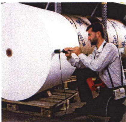
Kuva 1. Kovuuden mittaus sekä paluu- ja iskuliikkeen nopeuksien määritelmä /85/.
