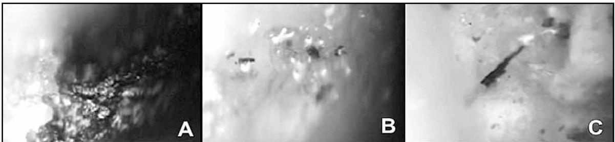
Fig. 5. 5. A-B: Pieza EU136: residuos de la pasta de resina utilizada en grietas de la microtopografía. Magnificación: 200X. Campo de iluminación claro. 5. C: Pieza EU141: residuos de "mastic" en cara dorsal. Magnificación: 200X. Campo de iluminación claro.
