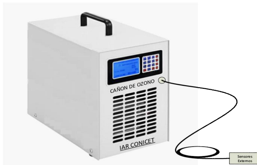
Figura 7. Aspecto externo del cañón de ozono desarrollado por el IAR. El modelo final muy probablemente se conectará con los sensores en forma inalámbrica.
