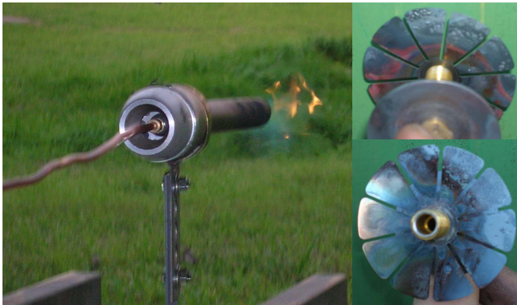
Figura 5: Pulsorreactor funcionando y Estado de las clapetas.
