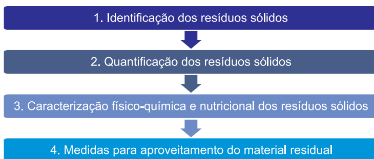
Figura 9. Principais etapas do gerenciamento de resíduos sólidos em uma unidade de processamento de pescado.
