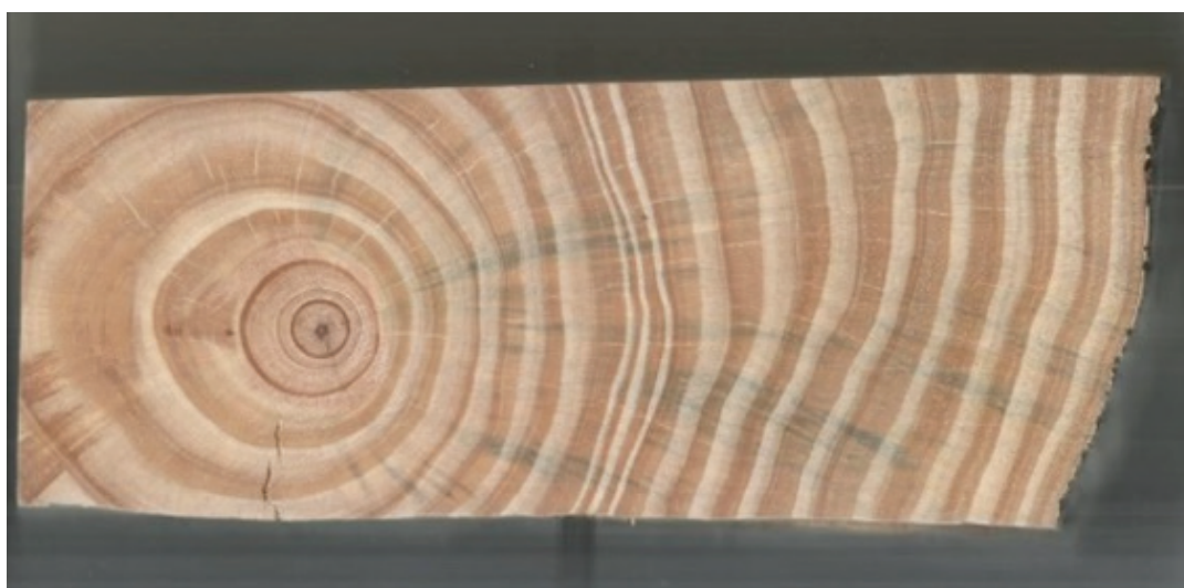
Figura 9. Amostra lixada e polida de lenho de Pinus para visualização e medição dos anéis de crescimento.
