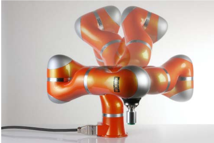
Bild 3.1: Nullraumbewegung, Redundanz der Grundachsen des LBR; Quelle: KUKA Roboter GmbH
