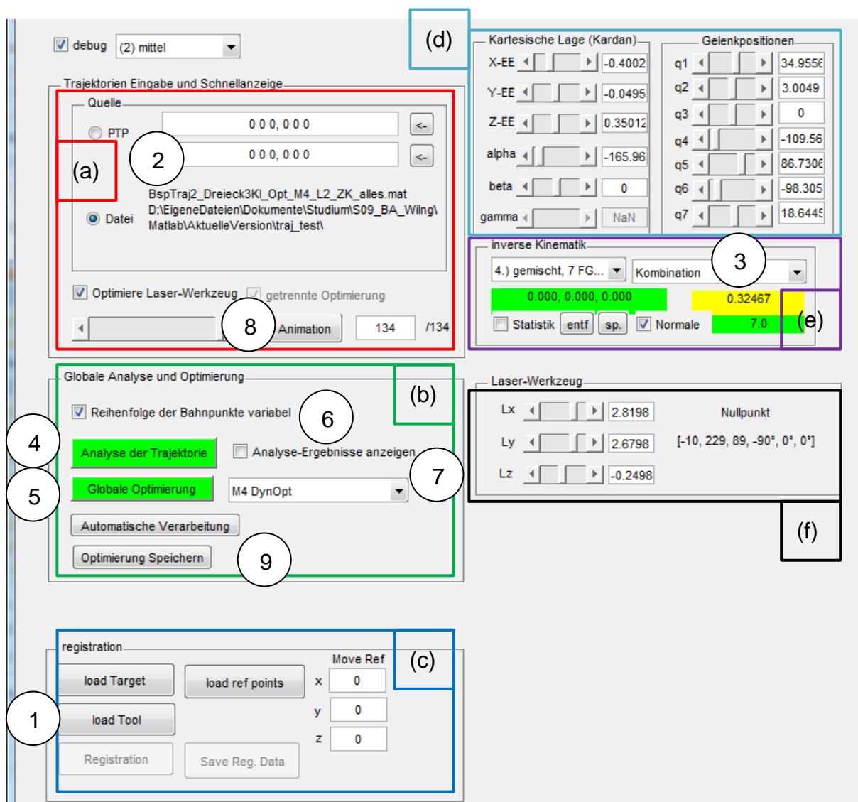
Bild 5.2: Linker Teil der GUI; enthält die Eingabe und Analyse der Trajektorie sowie Eingabe und Anzeige der kartesischen Lage und Gelenkwinkel
