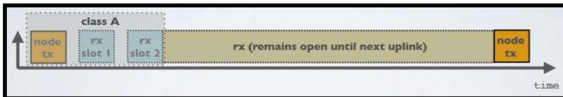
Figura 8 – Modo de funcionamento de uma classe C [20]
