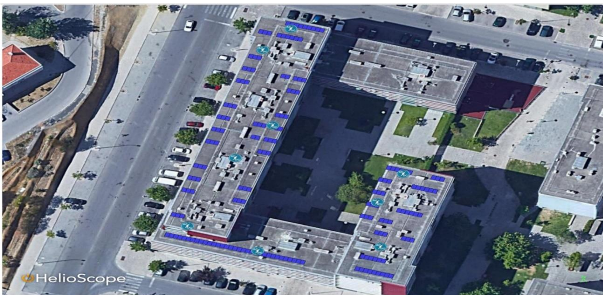
Figura 11: Disposição do sistema fotovoltaico proposto, via HelioScope (1:10) [81]
