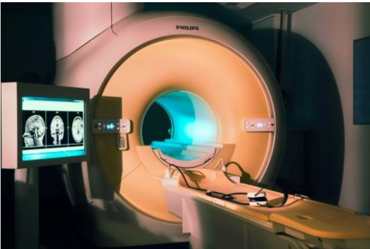
Abbildung 3.3: Magnetresonanztomograph mit Versuchsaufbau für real-time fMRT Messung; Philips, Ingenia; mit freundlicher Genehmigung von Frank Lübke
