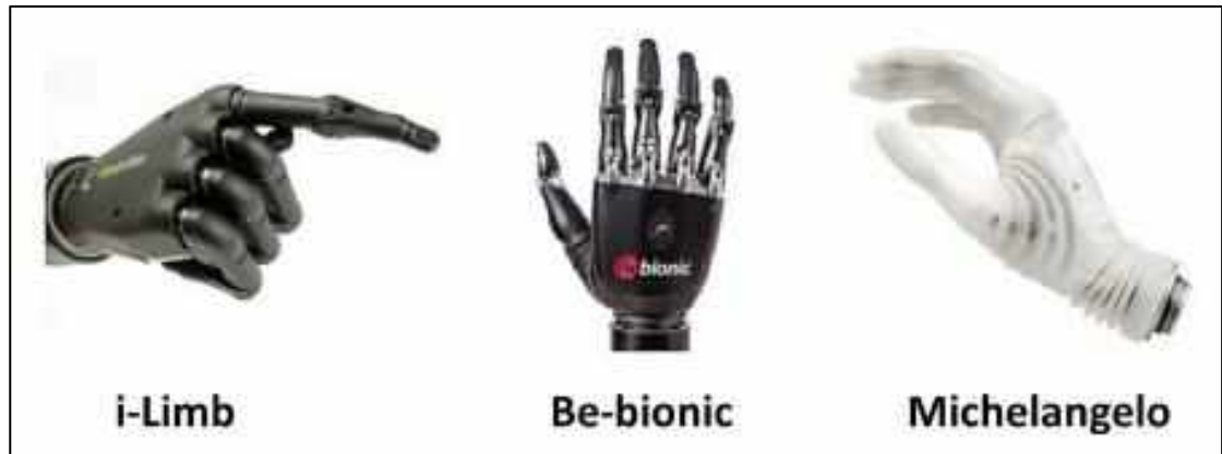
Figura 10: Mãos protéticas, com controle mioelétrico, mais avançadas disponíveis no mercado. Fonte: Cordella (2016).
