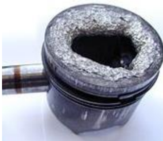
Figura 4: Esempio di pistone danneggiato da detonazione
