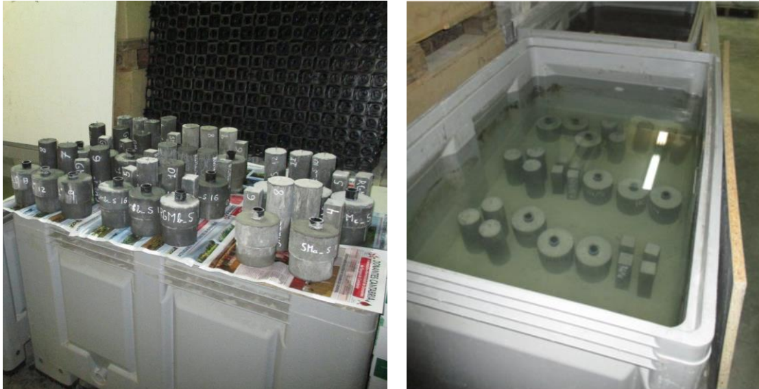
Figura 22: Retirada del molde (izq.) y curado de las probetas en un tanque con agua a 20°C (dcha.)
