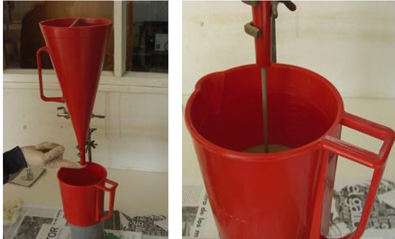
Figura 23: Determinación de la viscosidad con el embudo Marsh
