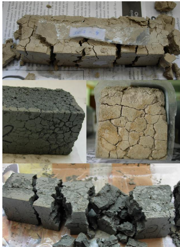
Figura 51: Daños producidos en los especímenes tras 7 ciclos hielo-deshielo
