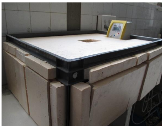
Figura 31: Baño termostático para el acondicionamiento de las probetas
