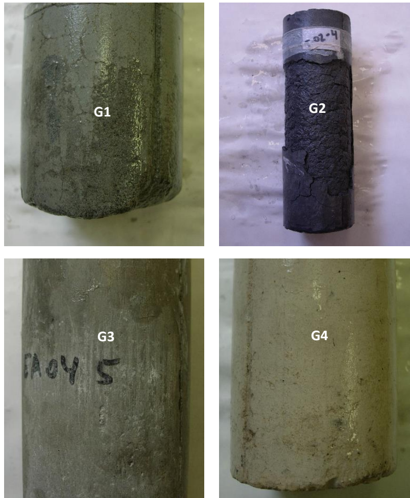
Figura 55: Probetas de conductividad térmica de los rellenos G1 a G4 tras 14 ciclos humedad-sequedad
