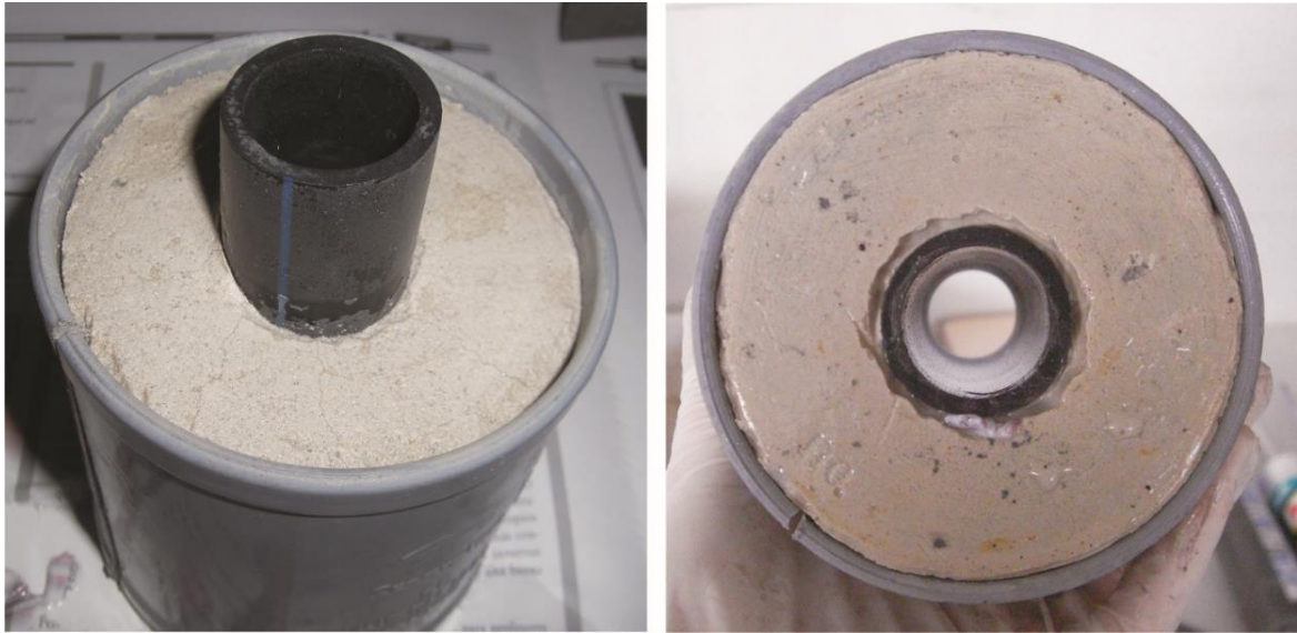
Figura 47: Vista del conjunto relleno-tubería tras 28 ciclos calor-frío.
