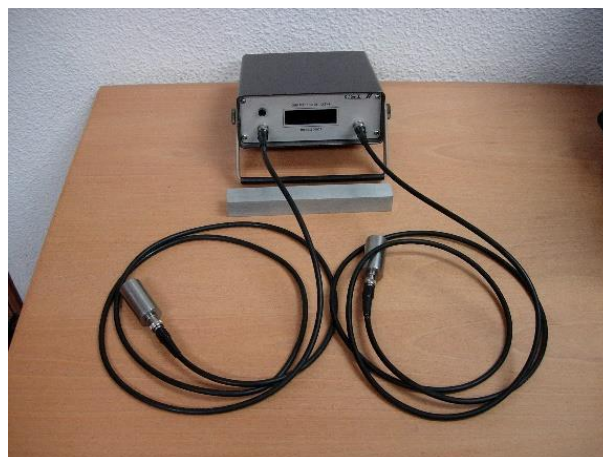
Figura 30: Dispositivo para la determinación de la velocidad de propagación de ultrasonidos
