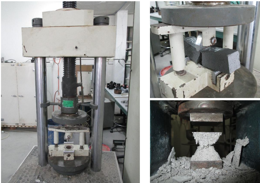
Figura 27: Equipo universal de ensayos (izq.), ensayo flexión (dcha. arriba) y ensayo compresión (dcha. abajo)
