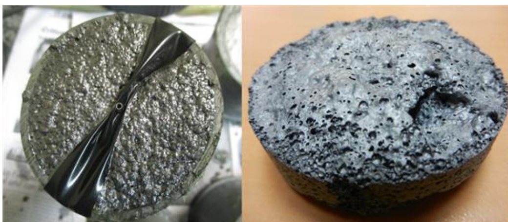
Figura 65: Costra formada en la superficie de la muestra cuando se añaden las escamas de grafito
