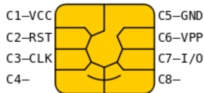
Figura 2.3 Contactos del chip de una tarjeta con contactos
