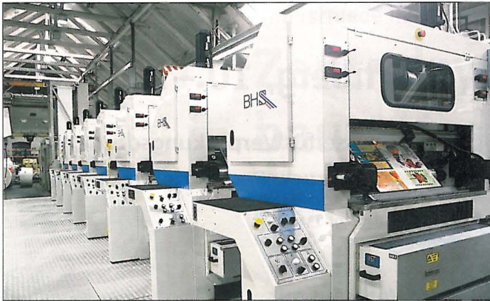
Reihen-Flexodruckmaschinen: Die Flexline Compact von BHS ist stufenlos formatvariabel und mit zahnradlosem Direktantrieb des Druckzylinders ausgestattet. Solche Anlagen sind aufgrund ihrer Bauweise auch für die Inline-Weiterverarbeitung besonders geeignet.
