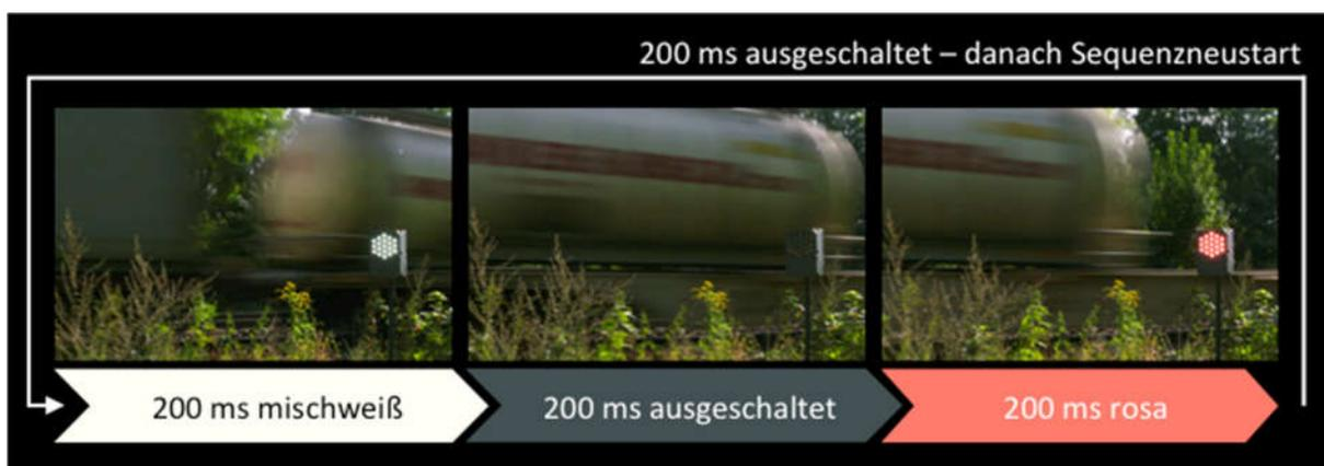
Abbildung 25. Lichtreizabfolge von PeriLight in den Versuchen: Die dargestellte Sequenz wird pro Leuchteinheit fünfmal durchlaufen.
