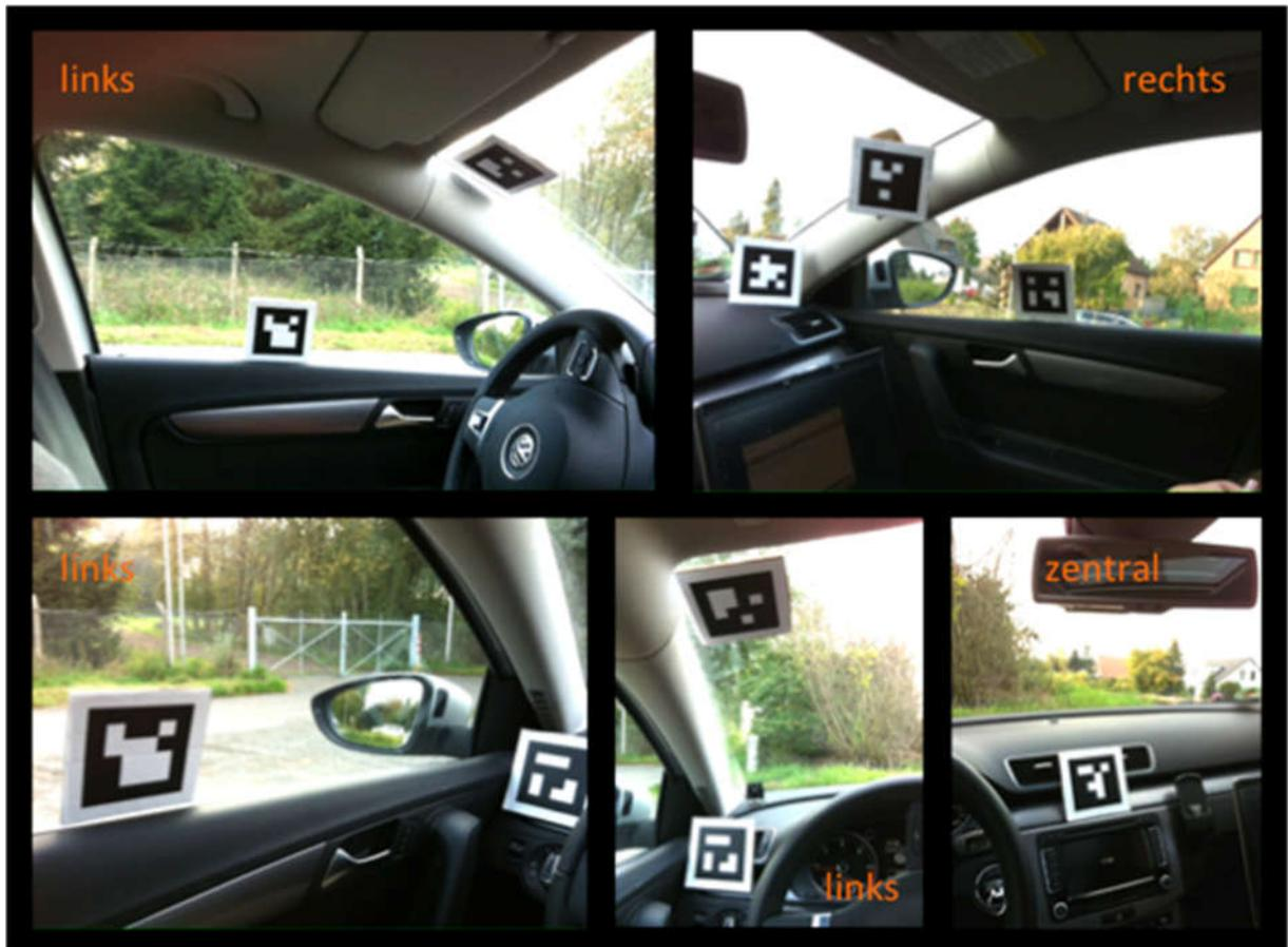
Abbildung 38. Eye Tracking - Marker im Versuchsfahrzeug
