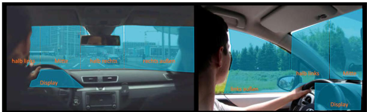
Abbildung 26. Für den Versuch definierte *Areas of Interest* zur Auswertung von Blickparametern.
