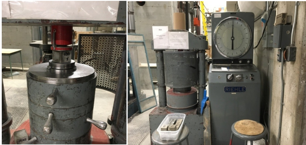
Figure 3.11 : Essai de compression sur cubes de mortier
