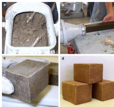
Figure 2.10 : Briques à base des sédiments du Savannah(Achour, 2013)
