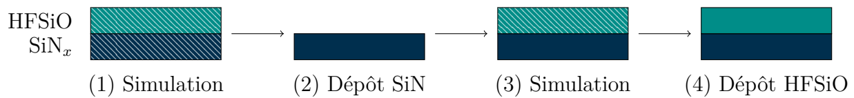
Figure 3.5 Démarche pour le dépôt de l'ARC. Le hachuré désigne les couches simulées et le plein les couches déposées. 1) Simulation des épaisseurs optimales. 2) Dépôt du \text{SiN} et mesure de l'épaisseur réelle. 3) Simulation de l'épaisseur optimale de \text{HFSiO} compte tenu de l'épaisseur réelle de \text{SiN} . 4) Dépôt du \text{HFSiO} .
