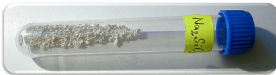
Figure 2.23 : Silicate de sodium : forme anhydre [16].
