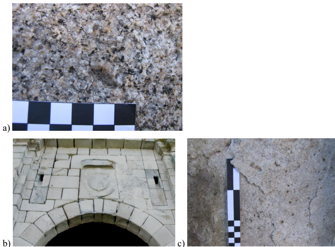
Fig. 3. Imagens ilustrativas de tipos de granitos encontrados na vila de Almeida: a) granito porfiroide de duas micas, dominante nas estruturas estudadas b) granito mais fino e claro encontrado na porta Magistral de Santo António; c) pedra granítica muito clara e fina (possível aplito) na fachada principal da Igreja da Misericórdia.
