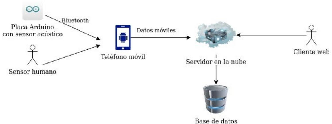
**Figura 1.1** Diagrama representativo de la estructura del sistema final
