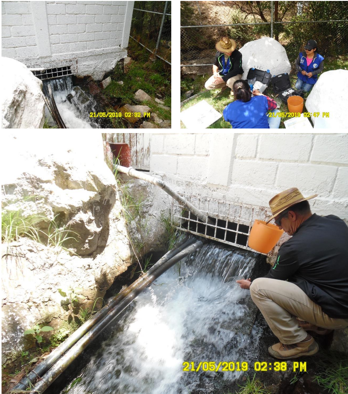
Figura 4.10. Medición el caudal del manantial Agua Azul.
